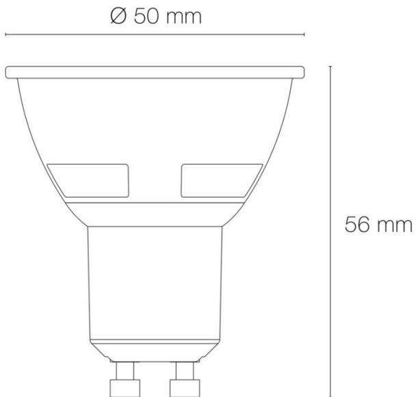
LAMPE LED GU10 3 IN 1 SWITCH EUROPOLE blanc 2700K/4000K/5000K, IRC80, 6W, 395lm (65,83lm/W), optique 38°, 230VAC, GU10, classe de protection II. Durée de vie : 20000h. Dimmable : Oui, variation TRIAC.
