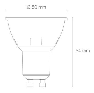
LAMPE LED GU10 EUROPOLE blanc 4000K, IRC90, 6W, 550lm (91,67lm/W), optique 48°, 230VAC, GU10, classe de protection II. Durée de vie : 20000h. Dimmable : Oui, variation TRIAC.
