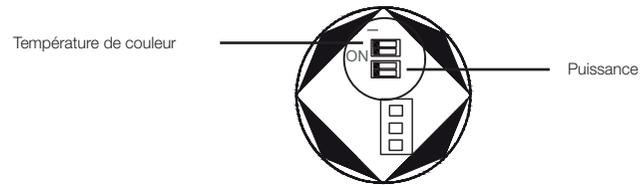
Position des interrupteurs de sélection (DIP switches)
