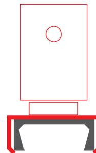
**3.** Montez le ruban à LED dans le profilé et faites passer le câble à travers un trou prépercé.
