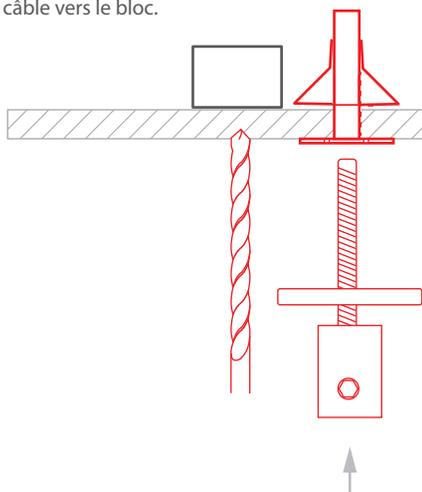
**6.** Montez le luminaire muni des tiges dans les pièces de fixation de plafond. Raccordez le câble d'alimentation.
