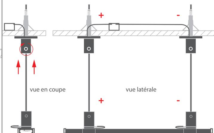
**1.** Percez un trou de 5 mm de diamètre dans le profilé choisi pour faire passer le câble électrique.
