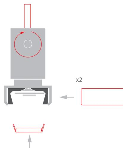
**5.** Installez les pièces de fixation de plafond W-KG. La notice d'installation des pièces de fixation peut être téléchargée sur [www.klusdesign.eu](http://www.klusdesign.eu). Placez le bloc d'alimentation à côté de la pièce de fixation et percez le plafond pour diriger le câble vers le bloc.
