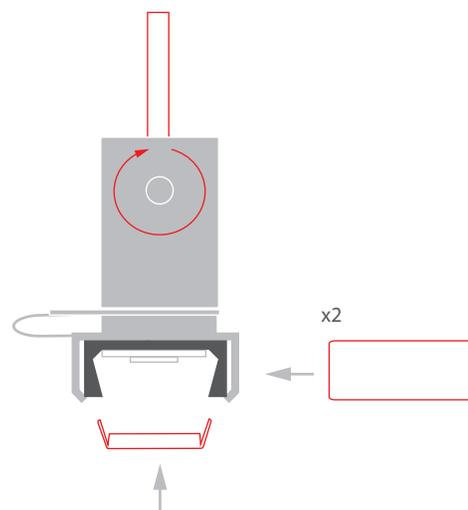
**5.** Installez les pièces de fixation de plafond W-KG-Z. La notice d'installation des pièces de fixation peut être téléchargée sur [www.klusdesign.eu](http://www.klusdesign.eu). Raccordez les câbles, un pour chaque conducteur d'alimentation, aux pièces de fixation. Les câbles doivent traverser le trou prépercé juste en dessous du cache de la pièce de fixation.
