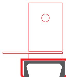
**3.** Montez le ruban à LED dans le profilé et faites passer les câbles à travers les petits trous prépercés. Puis dirigez-les vers les connecteurs des pièces de fixation DP-MOC-ZZ. Chaque trou doit laisser passer un câble avec un conducteur d'alimentation, le ruban à LED doit être coupé avant l'installation pour que les fils puissent être facilement dirigés vers les trous.
