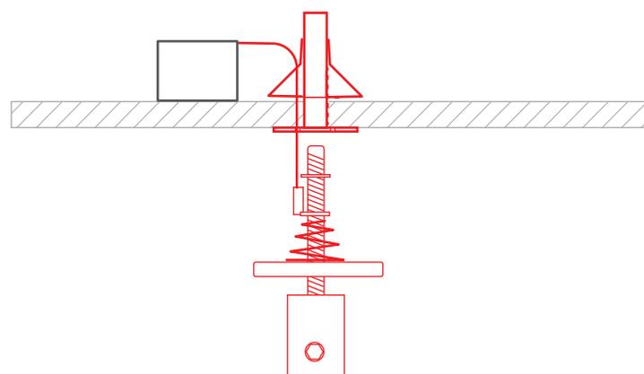
**6.** Montez le luminaire muni des tiges dans les pièces de fixation de plafond. Vérifiez bien que les conducteurs d'alimentation raccordés aux tiges correspondent à ceux raccordés aux pièces de fixation.
